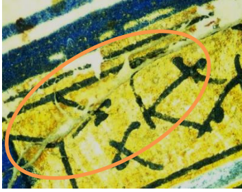
Serlevhadaki ek kâğıt birleşimin mikroskop görüntüsü
