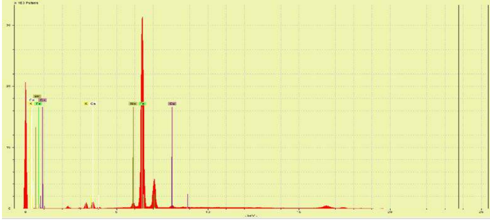
Şekil 1. Siyah mürekkep hattı XRF spektrumu
