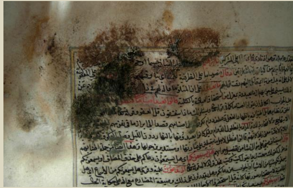
Yazma eserlerde küf gelişimi sonucu kâğıtta görülen renklemeler
